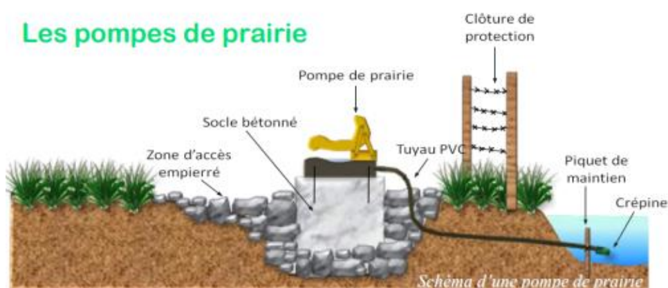
Exemple de mise en défens : clôture et pompe à museau
